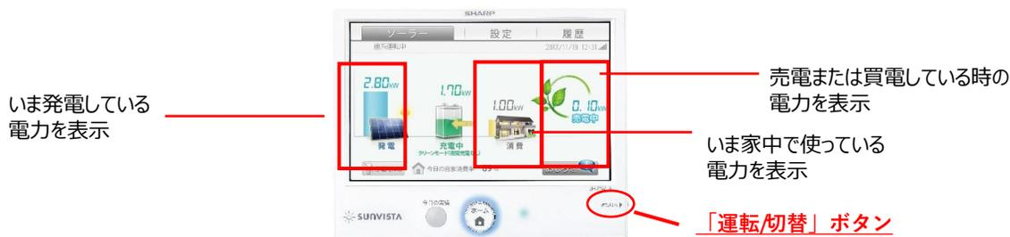
③停電時の電源として使用するには「自立運転モード」への切り替えが必要です。
