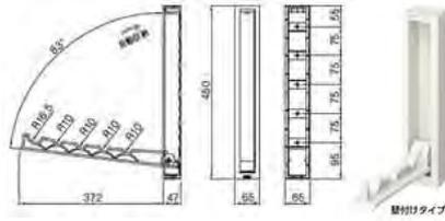
雨の日など、室内で洗濯物を干したい時にとっても便利な室内壁付け用物干し竿受けです。ソフトクローズ機構付で手を離すとアームが自動で戻ります。樹脂製、ホワイト色、2個で1組です。
